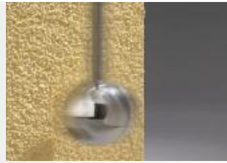
Sovatherm EPS Premium hybrid ist extrem stoßfest. Geprüft und bestätigt durch KIWA Polymer Institut GmbH, Flörsheim.
